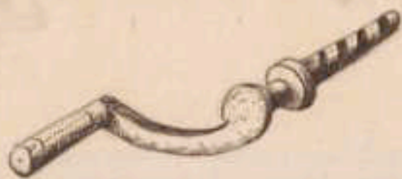
Vys sans fin propre pour forcer et rompre des Barreaux de fer 1.
