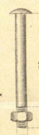
3 Tornillos para el soporte delantero.
