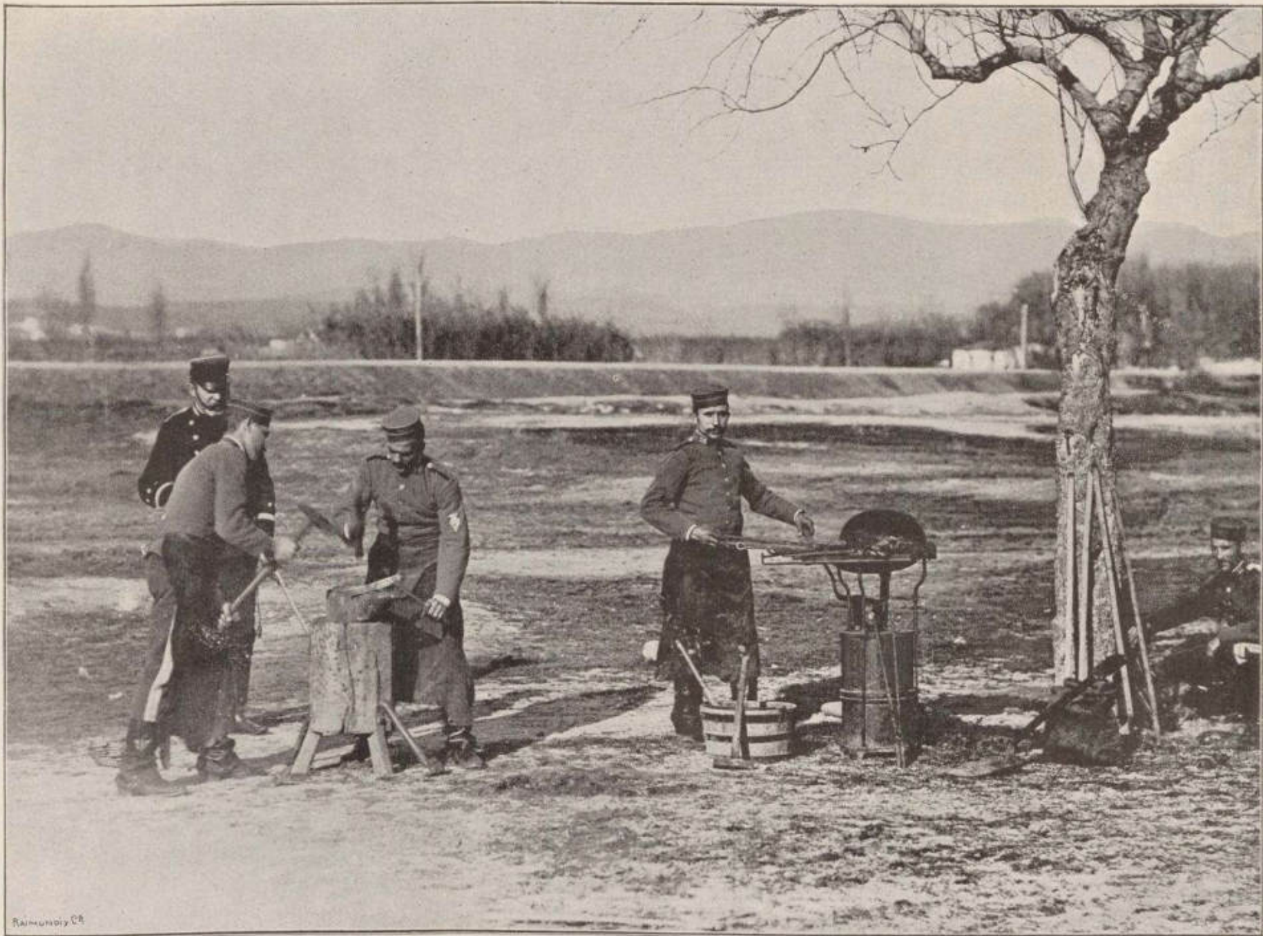
HERRERÍA DE CAMPAÑA. —Siendo de imperiosa necesidad el herrado de los caballos, en la presente autotipia trasladamos el momento en que unos herreros militares, bajo la vigilancia del señor oficial facultativo, construyen unas herraduras, á cuyo fin van en un carro del escuadrón todos los útiles indispensables para ello.
