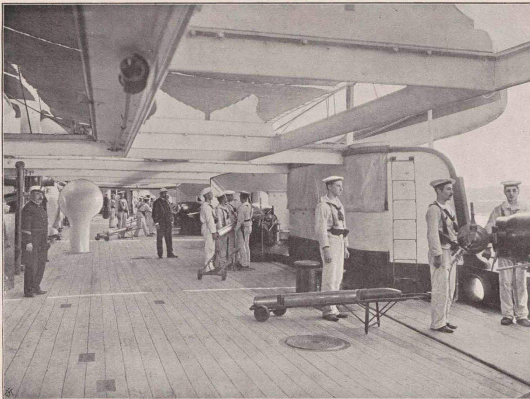
BATERÍA EN UN ACORAZADO DE 1. a CLASE. —Ejercicios á bordo de un acorazado de 1. a clase, en el momento de cargar los proyectiles. Éstos, para cuya conducción se emplean carretones exprofeso, son levantados á mano é introducidos por la recámara: llevan consigo la carga, como sucede en los fusiles Remington. Los cañones, que hacen 20 disparos por minuto, son de sistema González Hontoria y alcanzan una distancia de 10 millas.
