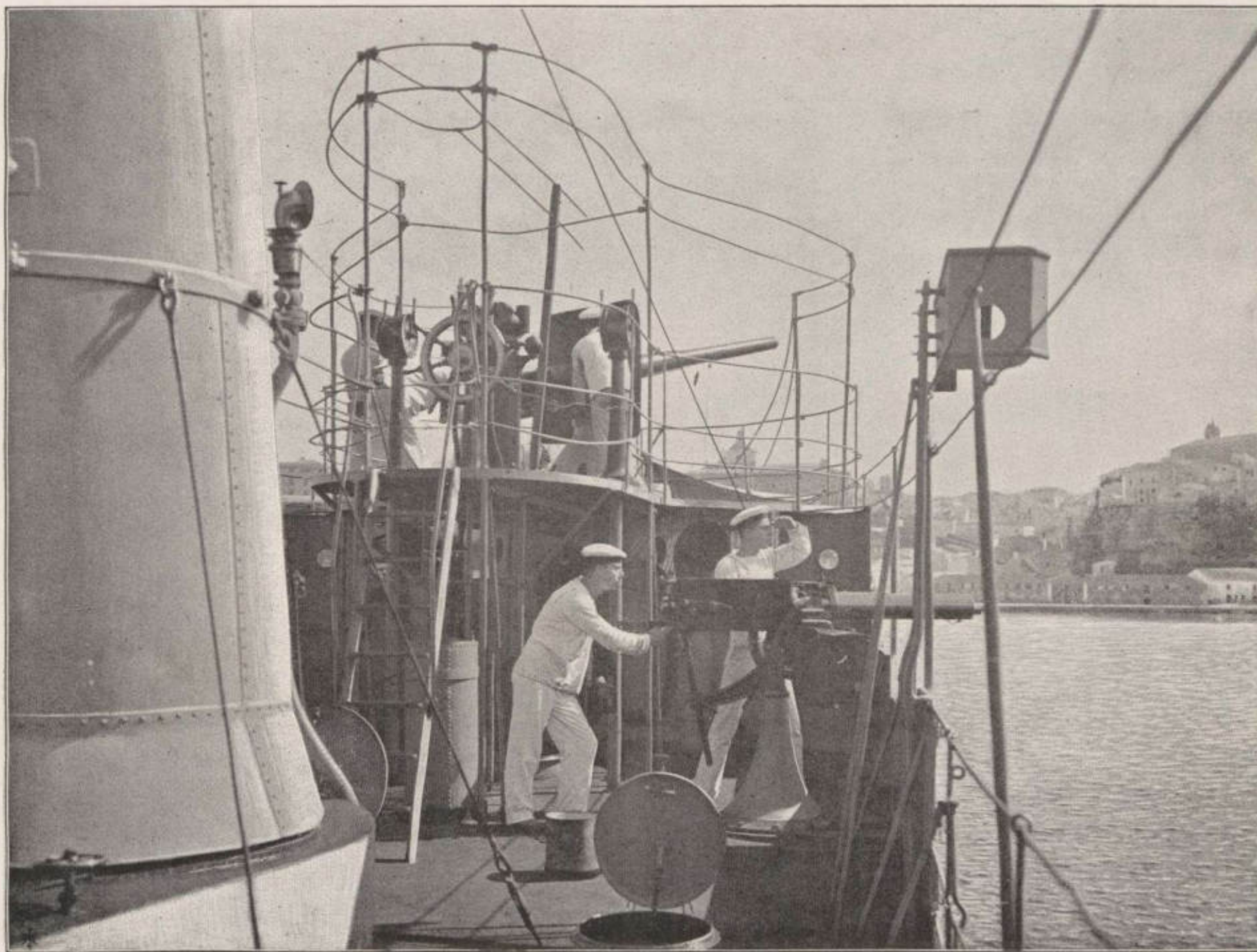
EJERCICIOS Á BORDO DE UN CAZA-TORPEDEROS (Destroyer). —Esta preciosa autotipia reproduce el momento en que los artilleros se ejercitan en el manejo de una ametralladora automática, sistema Máxim-Nordensfeld, hoy por hoy el arma más rápida en su clase, pues hace trescientos disparos de granada por minuto.
