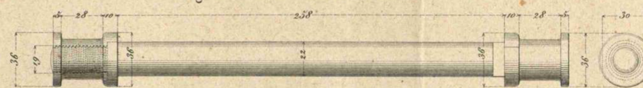
Fig a 4 a -Perno de contera con bolones
