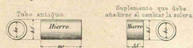
Tubos para centrar la solera de hierro (2/5)
