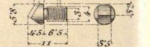
Teton de acero. Rosca izquierda.
