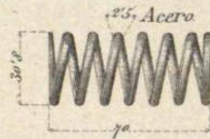
Muelle helicoidal para el cerrojo (1/10)
