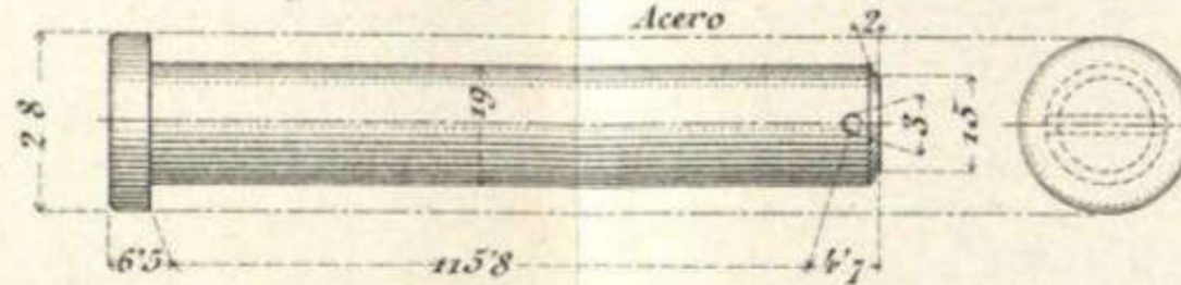
Eje de giro del porta-cierre. Acero.
