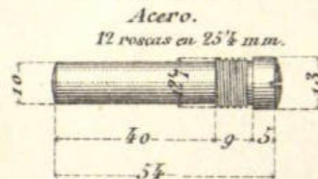
Eje para articular el extractor.
