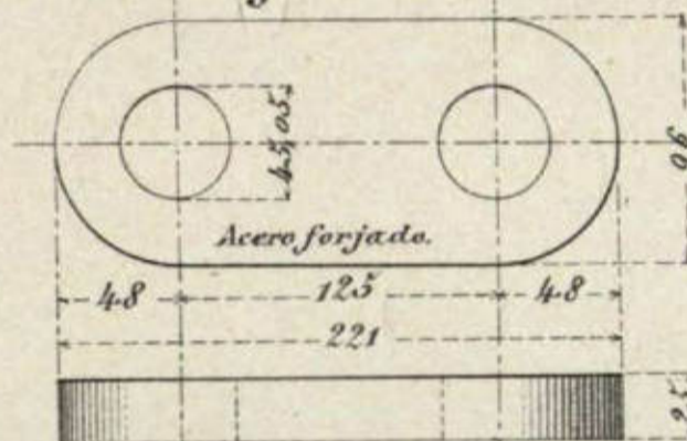
4 Ejes con volandera y pasador para las articulaciones. (E=2/10) Acero forjado.
