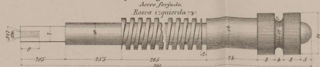
1 Husillo para caja inferior. (E. 1/1.) Acero forjado. Rosca izquierda
