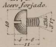
1 Tornillo retenida. (E. 1/1.) Acero forjado.
