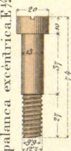
Tornillo para la palanca excentrica. E 1/2.
