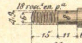
2-Tornillos para el muelle de seguro de cierre (E=1/2)
