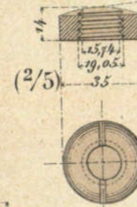
1-Tuerca p a el tornillo de la palanca excéntrica
