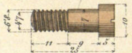
2-Tornillos para el muelle de seguro de cierre. E 1/1.
