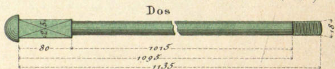
Pernos de unión de larguero y viguetas (E 1/5)
